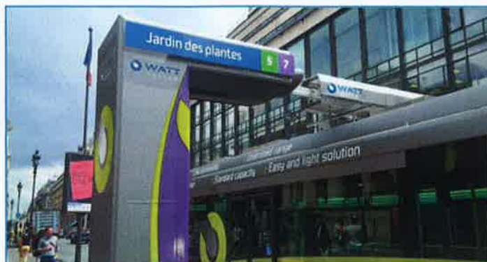
PVI a mis au point ce dispositif de rechargement électrique aux arrêts. Les deux prises se joignent.
